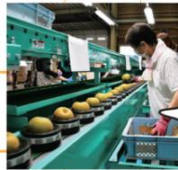
光センサーで糖度や内部を検査し、ひとの目による検品。カメラで撮影して傷や形、色づきもチェックし、一定の基準をクリアしたものが出荷されます。
